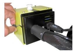
4. Entnahmerohr einstecken und mit Überwurfmutter nur handfest festziehen
