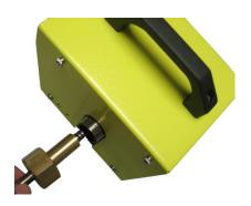
5. Sonde gasdicht an Entnahmeöffnung bzw. Prozessflansch montieren und JPES mit Montagekette abhängen
