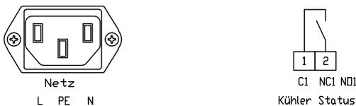
Der Anschluss an die Netzversorgung erfolgt über die IEC Buchse.
