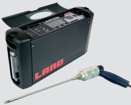
燃烧和排放监测
